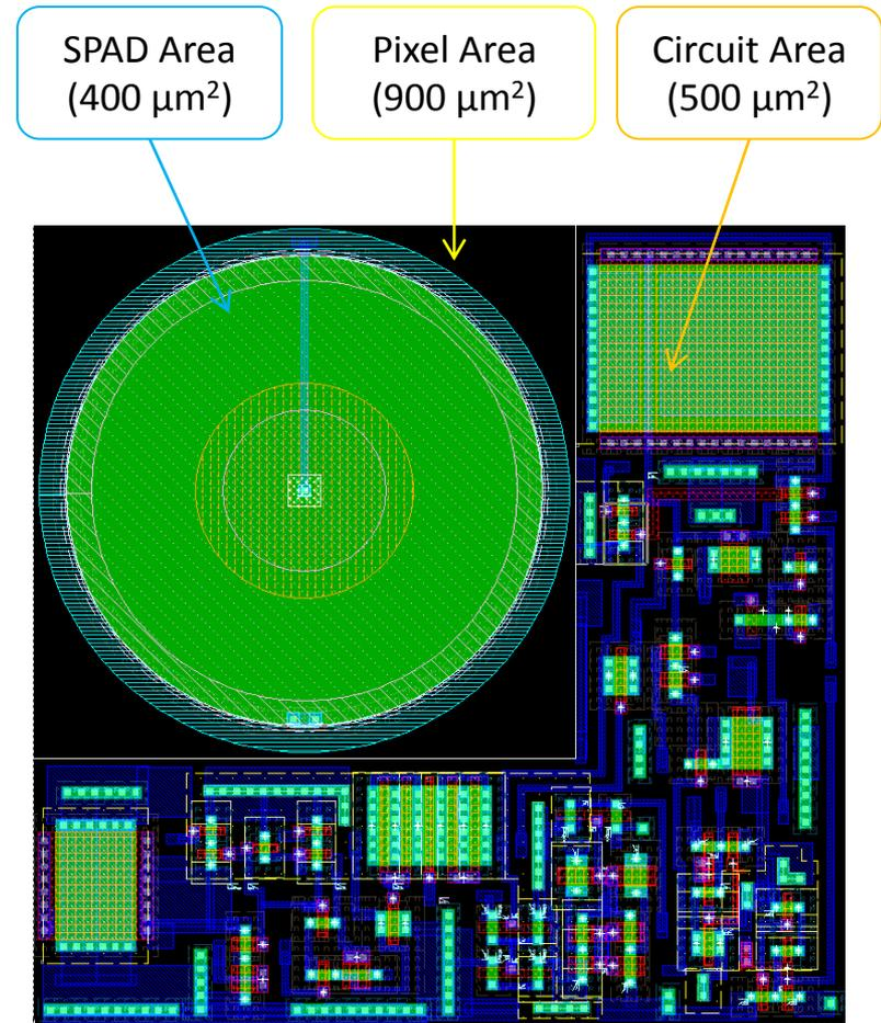
DSPAD Pixel Layout (30- $\mu\text{m}$  pitch)
