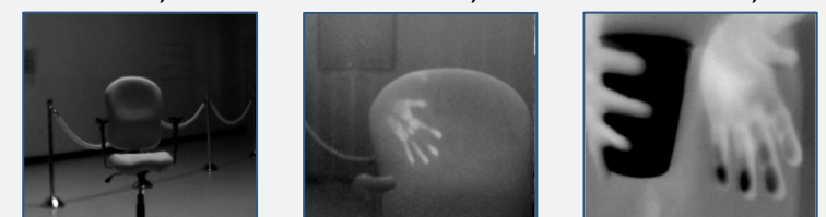
NIR on Si, 298K MWIR on CZT, 140K LWIR on CZT, 85K
