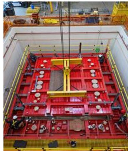
SBND Cryostat + Top Cap
