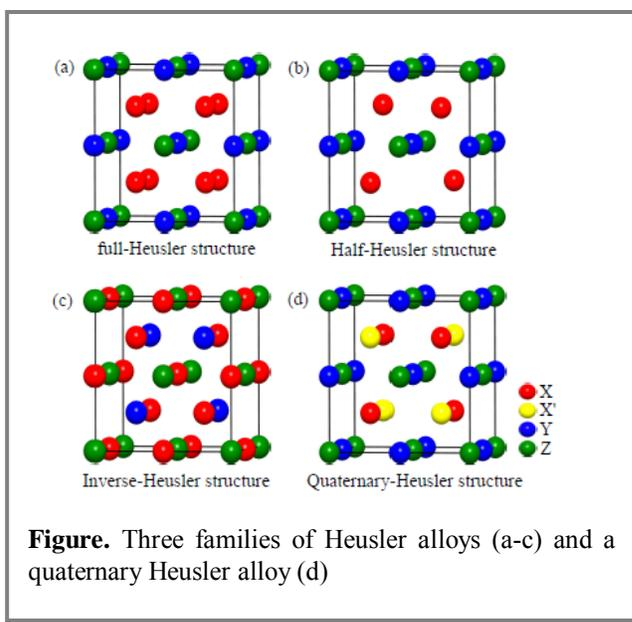
**Figure.** Three families of Heusler alloys (a-c) and a quaternary Heusler alloy (d)
